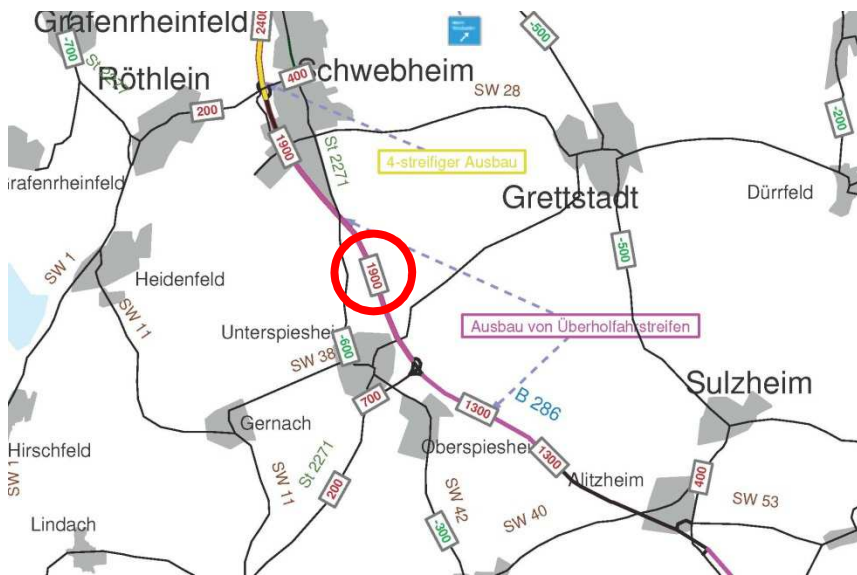
Abbildung 10: Planungsfall 4a (Verkehrsnachfrage 2035) - Differenzen zum Prognosenullfall 2035 (DTV) (Auszug aus dem Verkehrsgutachten „B 286 Schweinfurt –Wiesentheid“, Plan 15)
